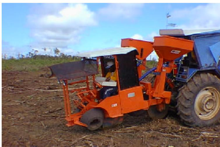
Figura 2 - Transplantadora de acionamento mecânico da marca Arador.
