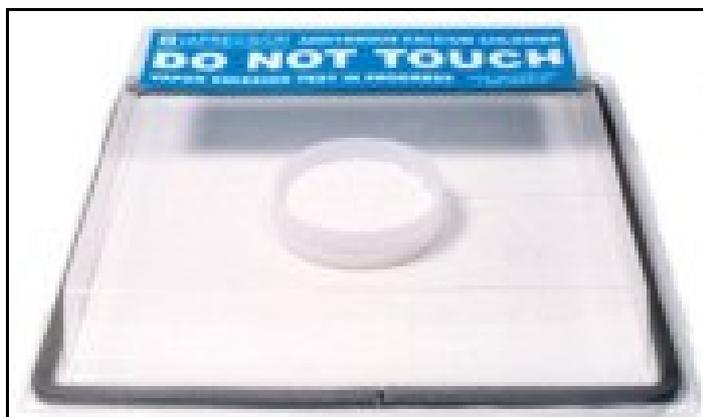
Figura 7 - Kit de testes TCCA para medir a taxa de emissão de vapor de umidade utilizando o cloreto de cálcio anidro (Fonte: VAPORTEST, 2004)
