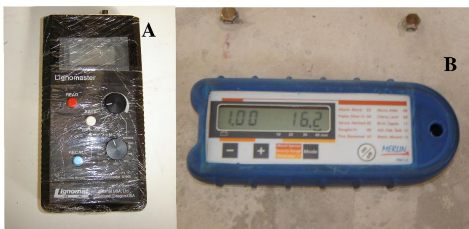
Figura 13 – Medidores elétricos de umidade: (A) medidor do tipo resistência, (B) medidor do tipo capacitivo
