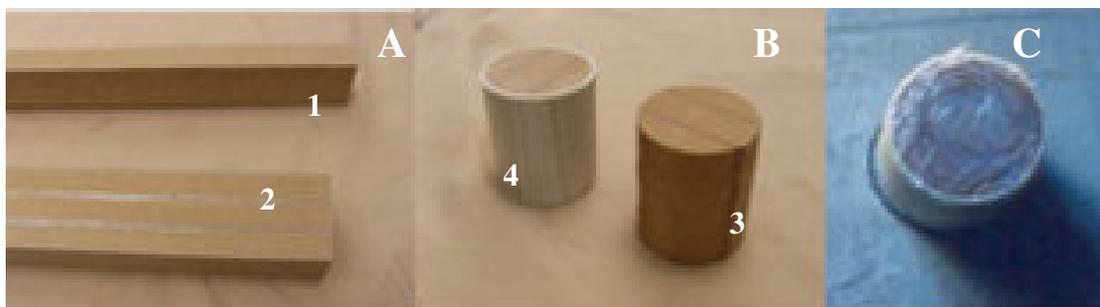
Figura 15 - Montagem dos corpos de prova de MDF: (1A) ripa individual de MDF; (1B) ripas coladas; (3B) ripas torneadas e cortadas; (4B) cilindro no interior do cano de PVC; (C) cilindros vedados com filme plástico e silicone
