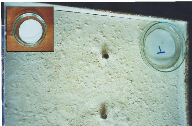
Figura 14 - Corpo de prova com o disco de papel de filtro. No detalhe, disco testemunha em placa de Petri
