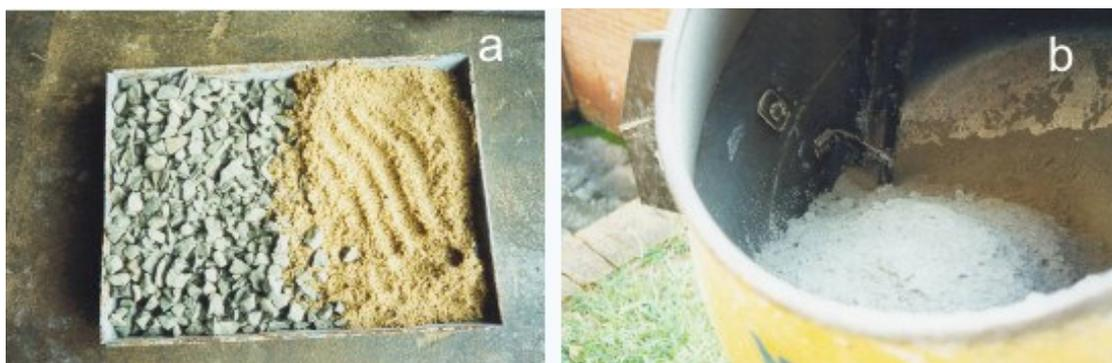
Figura 10 – Materiais utilizados para preparação do concreto, (a) areia média e brita 1, (b) componentes do concreto na betoneira
