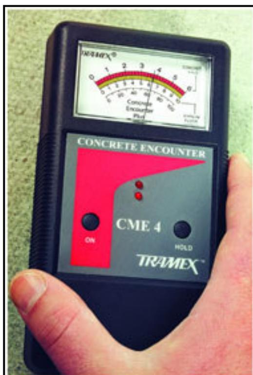
Figura 6 - Medidor modelo TRAMEX CME 4 (Fonte: TRAMEX, 2004)
