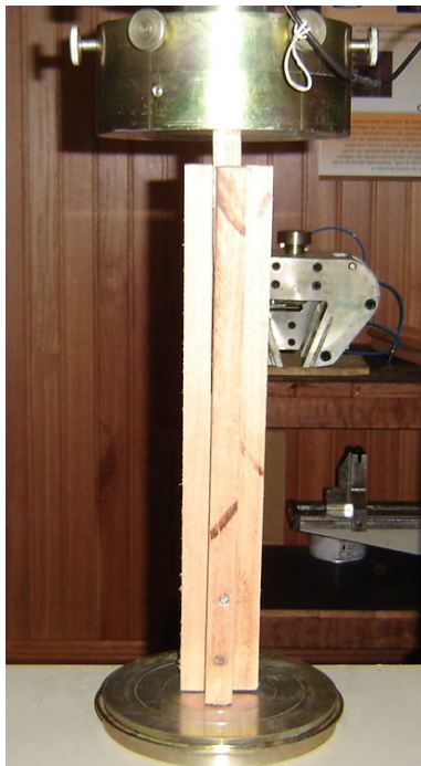
Figura 17 – Primeiro aparelho inventado para aplicar pressão controlada na colagem de corpos-de-prova
