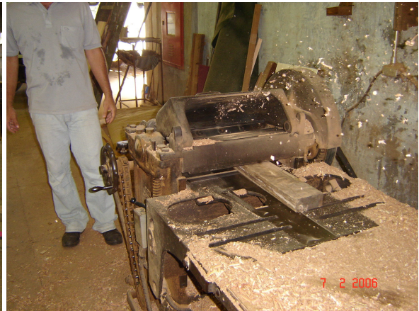
Figura 14 – Regularização da espessura na Plaina Desengrossadeira
