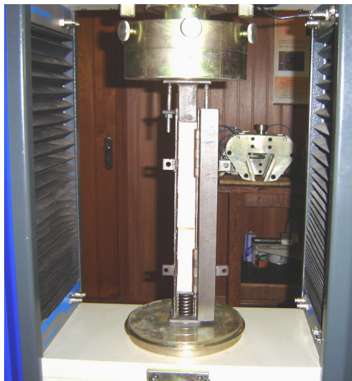
Figura 29 – Aplicação de pressão numa máquina universal de ensaio
