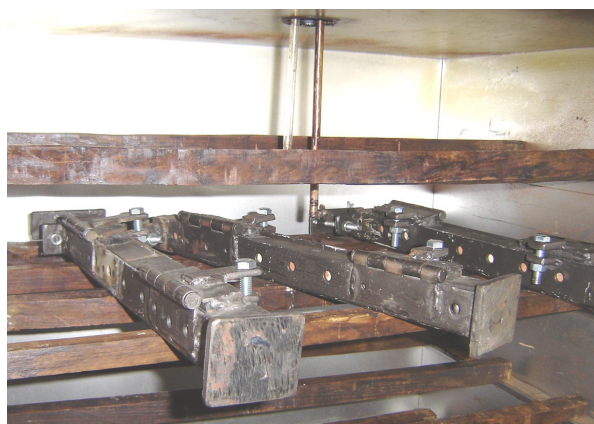
Figura 30 – CP's no interior da estufa sob pressões controladas segundo os tratamentos planejados.
