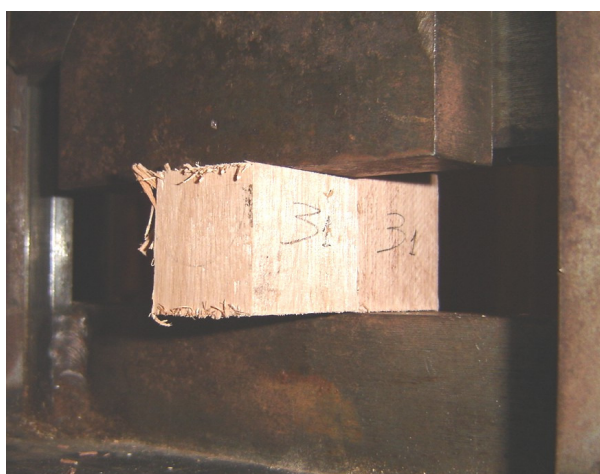
Figura 32 – Detalhe do CP durante o ensaio de cisalhamento no plano de cola
