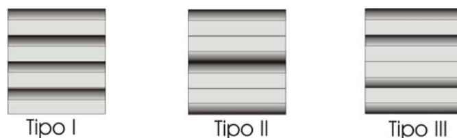
Figura 14 – esquema de colagem dos LBLs Fonte: Nugroho e Ando (2001) adaptada
