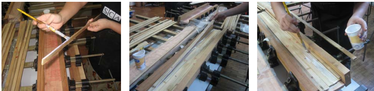
Figura 21 - Aplicação do adesivo na face lateral (a), montagem da primeira camada do compósito (b) e aplicação do adesivo na superfície da primeira camada (c)
