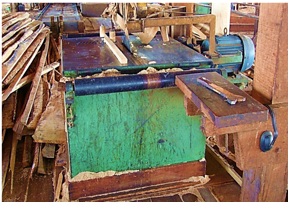
Figura 4 - Serra circular de bancada
