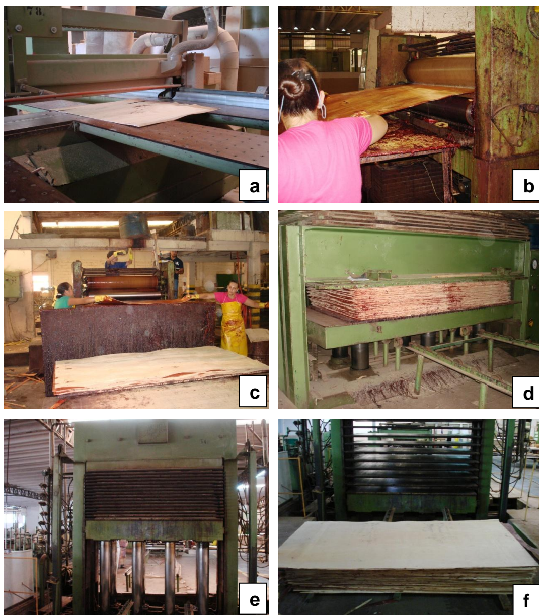
Figura 7 – Fabricação de painéis compensados; (a) corte das lâminas transversais; (b) aplicação de cola nas lâminas; (c) montagem do painel; (d) pré-prensagem a frio; (e) prensagem a prensa quente; (f) saída dos painéis da prensa
