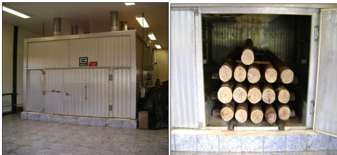
Figura 3. Aplicação do tratamento de vaporização em toras.
