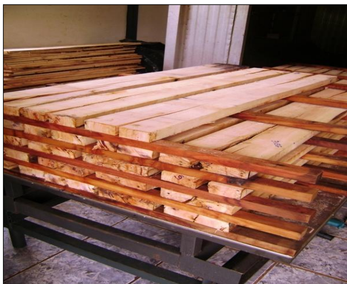
Figura 6. Empilhamento gradeado para secagem das tábuas centrais com 40 mm de espessura.
