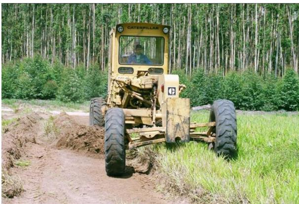
**FIGURA 12.** Raspagem do solo para retirada da braquiária
