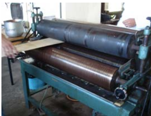
Figura 13. Aplicação do adesivo com o aplicador de rolo.
