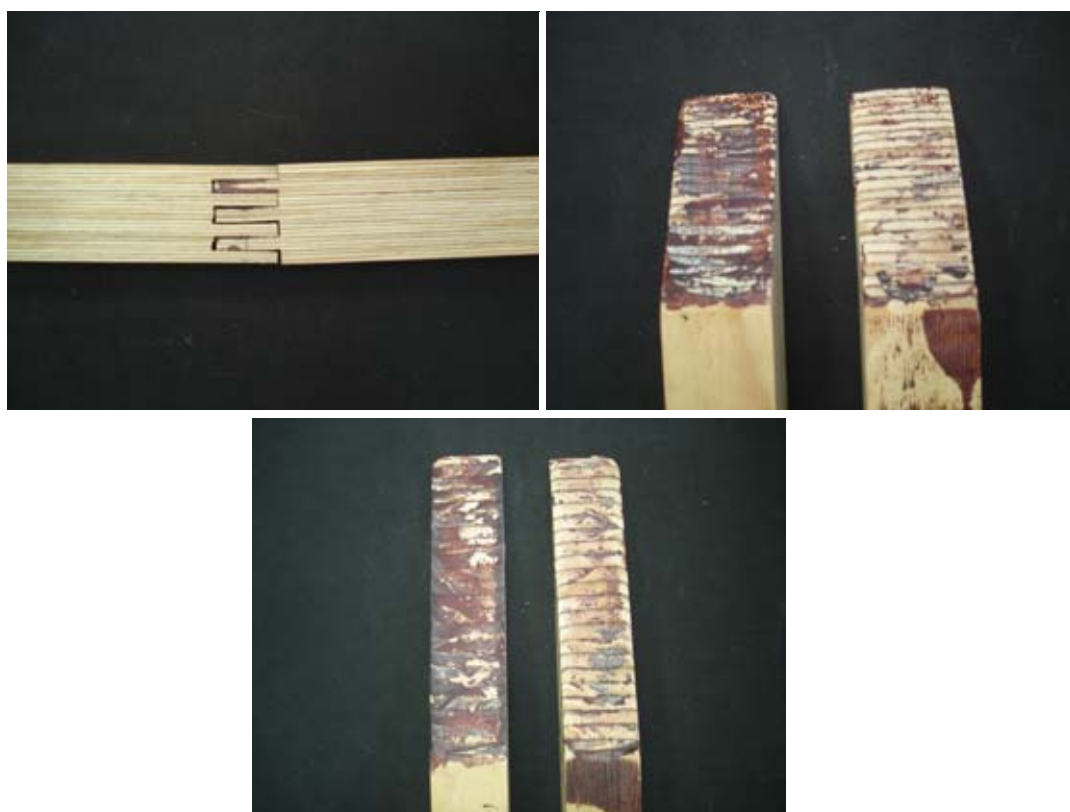
Figura 23. Ruptura das emendas macho-fêmea, bisel 1:2, e bisel 1:4.
