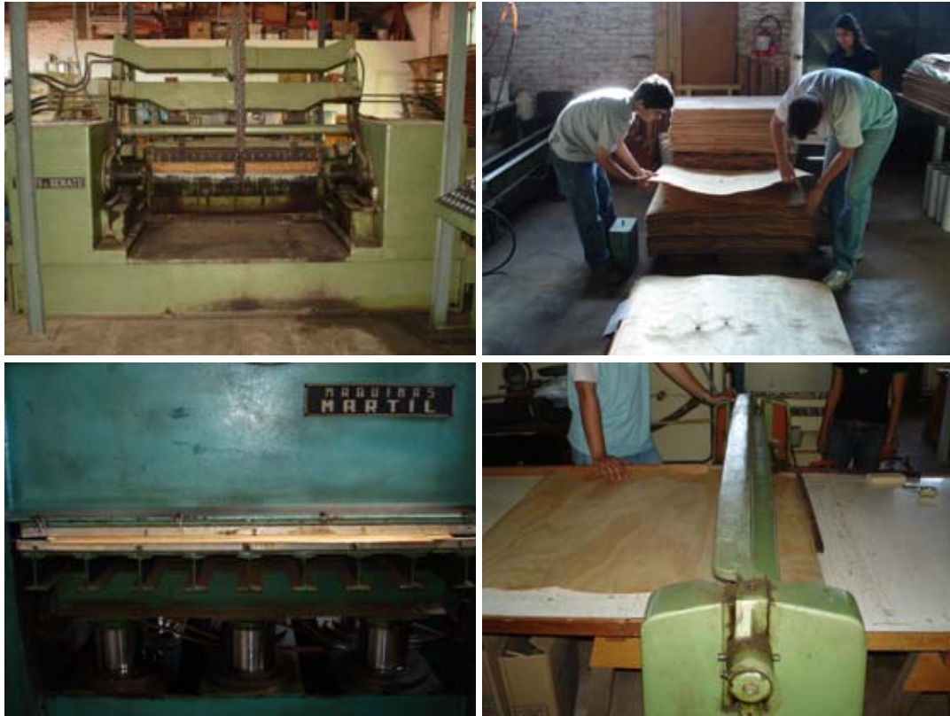
Figura 11. Etapas para obtenção das lâminas de madeira: laminação, classificação, ressecagem e guilhotinamento.
