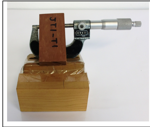
Figura 13 - Micrômetro utilizado na mensuração dos corpos-de-prova
