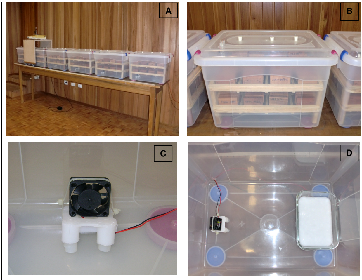
Figura 10 - Condicionamento dos corpos-de-prova (A = sala de climatização; B = caixa de condicionamento; C = ventoinha para ventilação interna; D = interior da caixa de condicionamento com sistema de ventilação e solução saturada)
