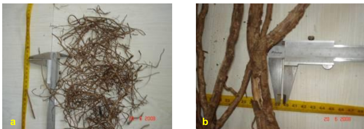
Figura 7 - Classificação das raízes em diâmetros menor (a) e maior que 3 mm (b)
