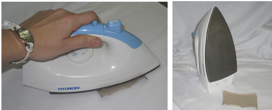
Figura 20- Preparação das amostras que foram submetidas às medições de cor em espectrofotômetro
