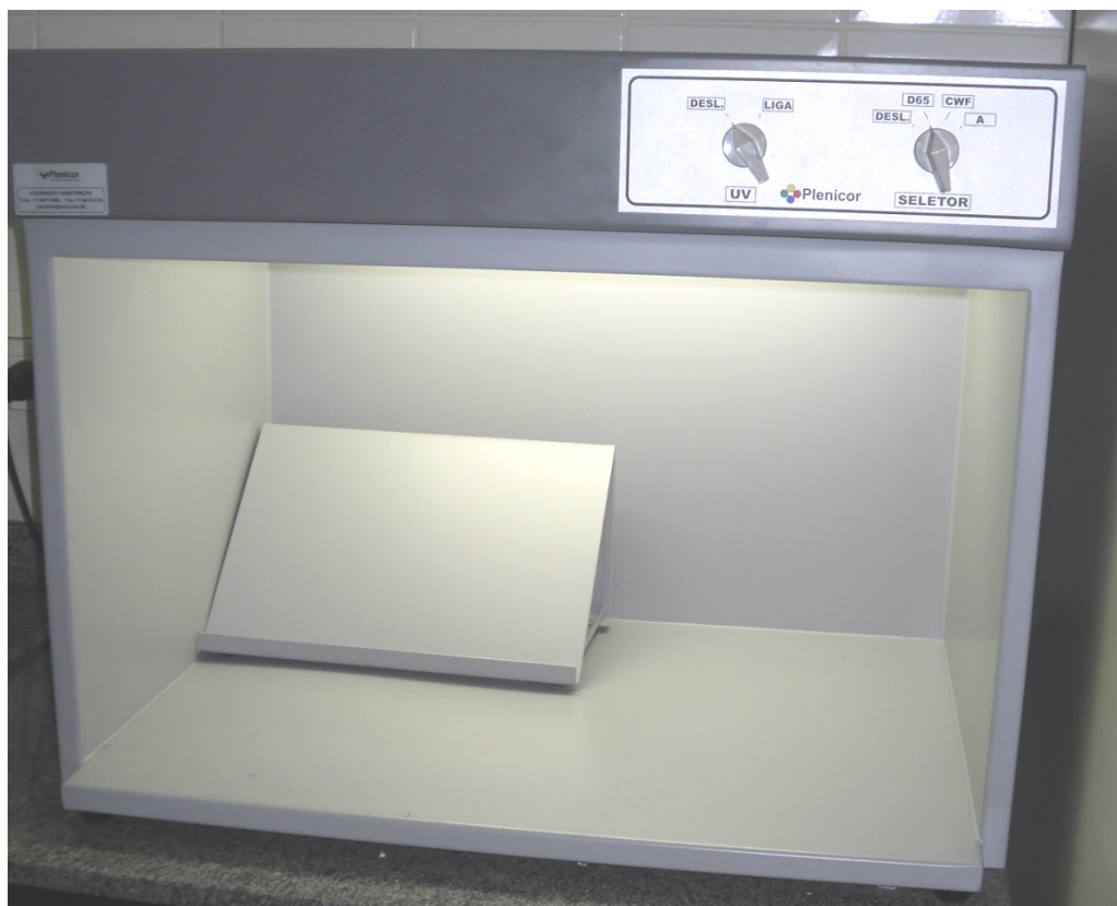
Figura 23 - Cabine de luz para comparação visual de cores dos tecidos tingidos, utilizando-se como iluminante CIE (D65)
