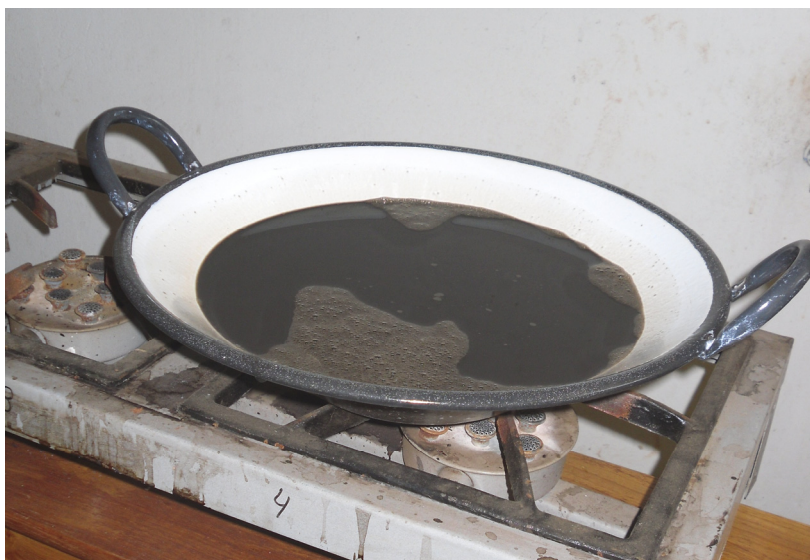
Figura 17- Concentração do resíduo efluente mediante aquecimento para evaporação d'água
