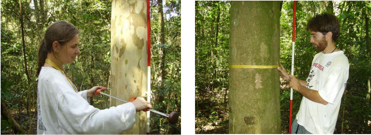
Figura 12 - À esquerda, medição do DAP com suta. À direita medição do CAP com auxílio de fita métrica
