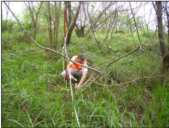
Figura 6 - À esquerda, a instalação de vértice de parcela com baliza e trena. À direita, estaca de madeira com a identificação da parcela
