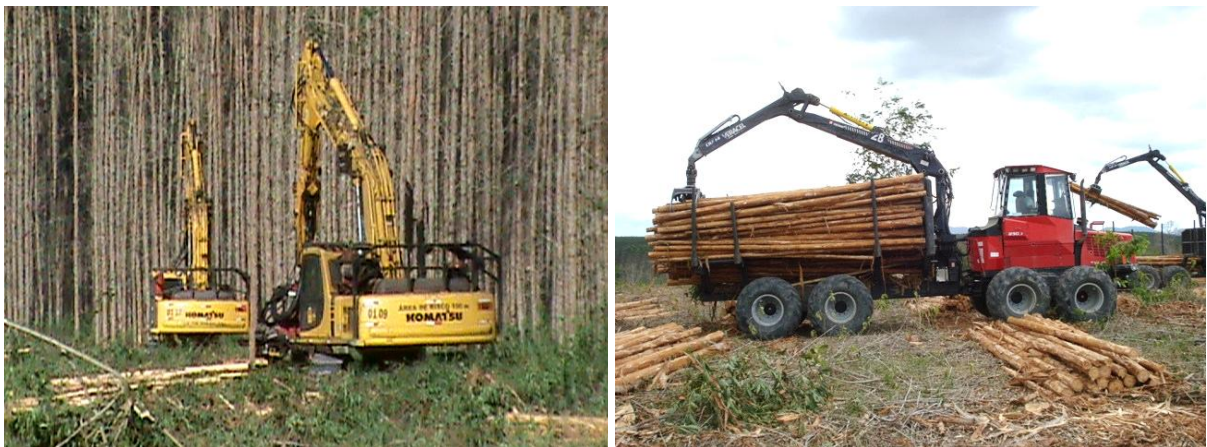
Figura 4 – Corte de Eucalyptus por harvester e extração com forwarder , Mucuri-BA
