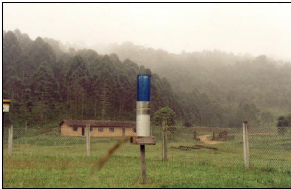
Figura 6 - Coletor de neblinas localizado na estação meteorológica do Núcleo Cunha.
