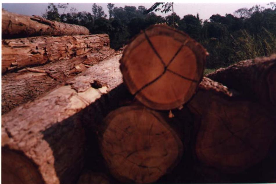
Figura 15 - Rachaduras de extremidade de tora.
