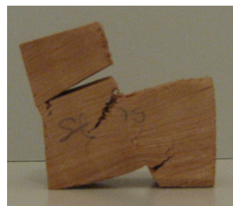
Figura 26 – Tipos de falha observados nos ensaios de cisalhamento de corpos-de-prova maciços
