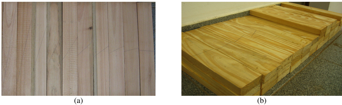
Figura 4 – Amostras de Eucalyptus grandis (a) e Pinus elliottii (b) usadas para obtenção de corpos-de-prova de cisalhamento
