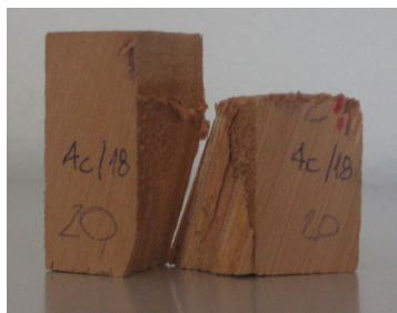
Falha mista de 75% na madeira de Eucalyptus grandis colado com Cascorez e ângulo do plano de cola de 20°
