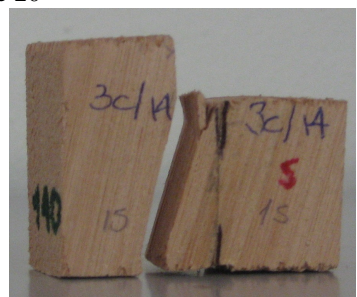
Falha na madeira de Eucalyptus grandis colada com Cascorez e ângulo do plano de cola de 15°
