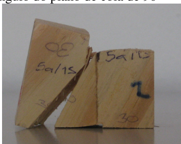
Falha mista de 90% na madeira de Pinus elliottii colada com Adespec e ângulo do plano de cola de 30°
