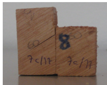
Falha dúctil, em Eucalyptus grandis colado com Cascorez e ângulo do plano de cola de 60°
