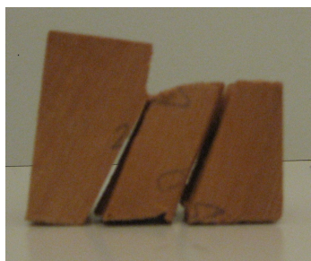
Figura 26 – Tipos de falha observados nos ensaios de cisalhamento de corpos-de-prova maciços
