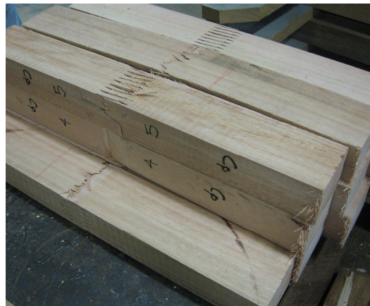
Figura 15 – Detalhe aplicação do adesivo Cascophen (a), aplicação da pressão de colagem (b) e lote de corpos-de-prova prontos com a emenda dentada na metade do seu comprimento (c)
