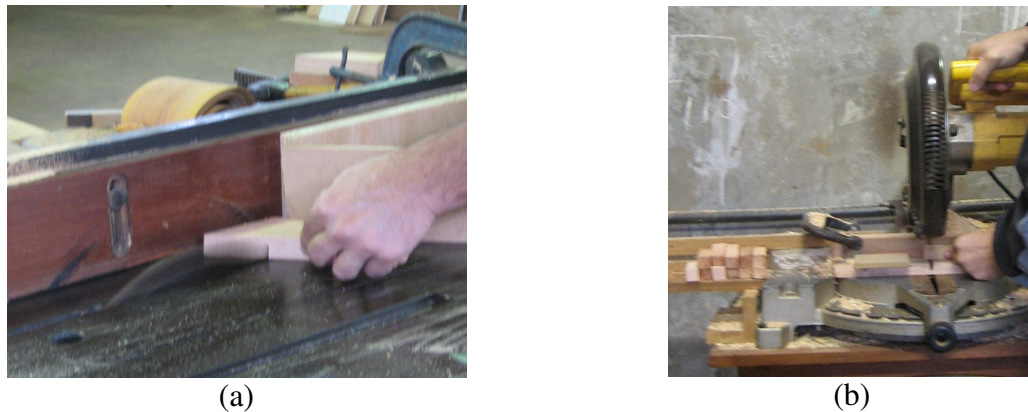
Figura 6 – Corte de regularização da largura dos corpos-de-prova corte em serra circular (a) e corte transversal do ajuste do comprimento em uma serra circular destopadeira (b)
