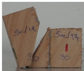
Falha na madeira de Eucalyptus grandis colada com Cascorez e ângulo do plano de cola de 30°
