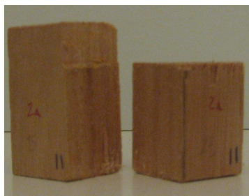
Falha na cola em Eucalyptus grandis colado com Adespec e ângulo do plano de cola de 5°
