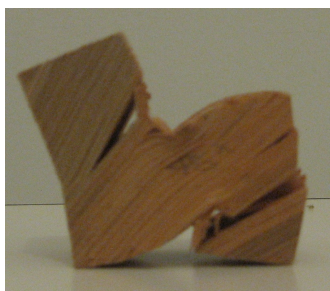
Figura 26 – Tipos de falha observados nos ensaios de cisalhamento de corpos-de-prova maciços
