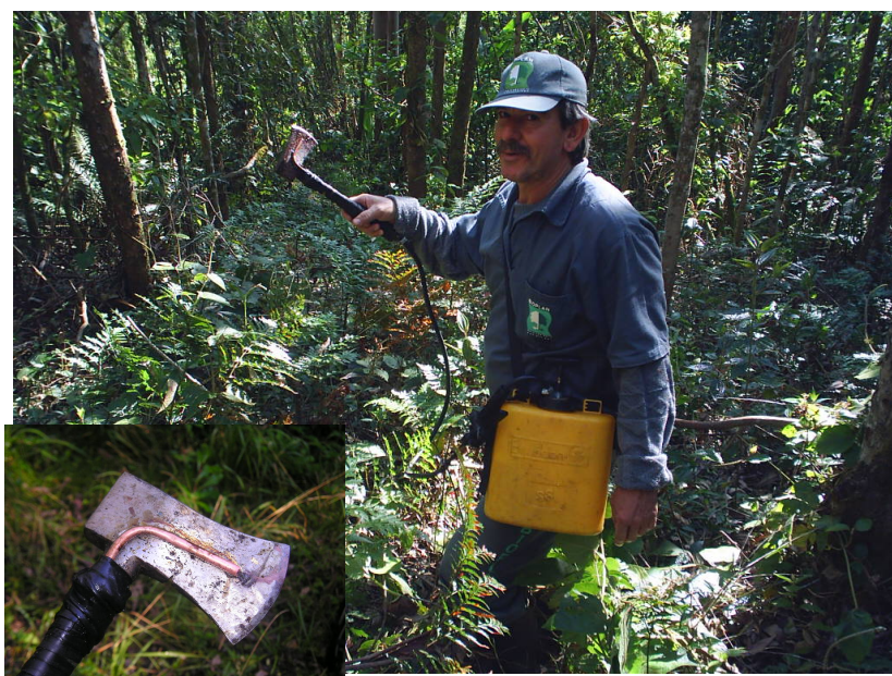
Figura 8 - Detalhe do “tree-injector” utilizado para a aplicação do tratamento
