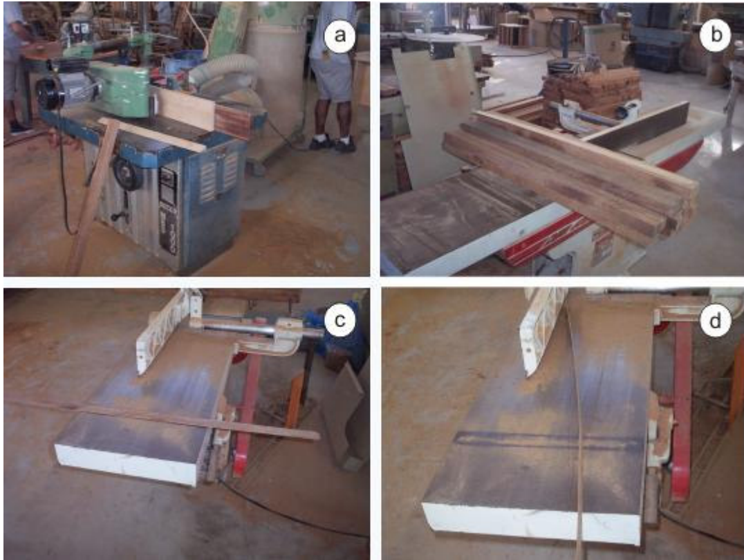
Figura 15 – Fabricação do pé dianteiro (Produtos 2 e 4) e do assento (Produtos 1, 2, 3 e 4), tupia onde eram processadas as peças (a), peças antes de serem processadas (b), lâmina pronta para ser colada (c), vista da espessura da lâmina pronta (d)
