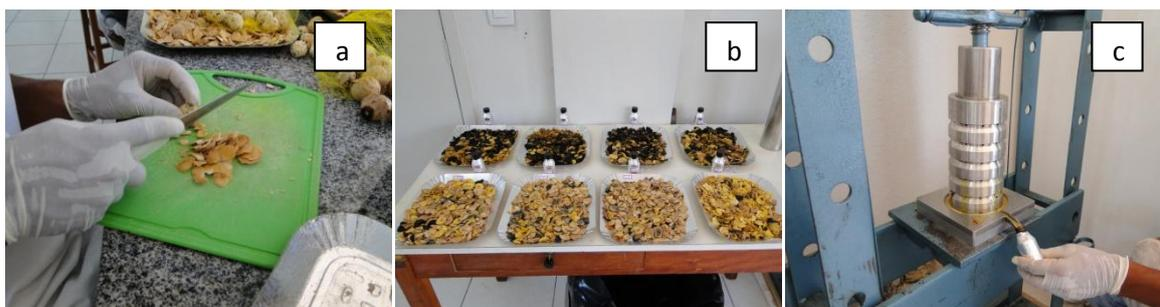
**Figura 3:** a) Despulpamento dos frutos; b) Organização das amostras para prensagem; c) Prensagem do mesocarpo e acondicionamento do óleo em frascos âmbar, envoltos por papel alumínio.
