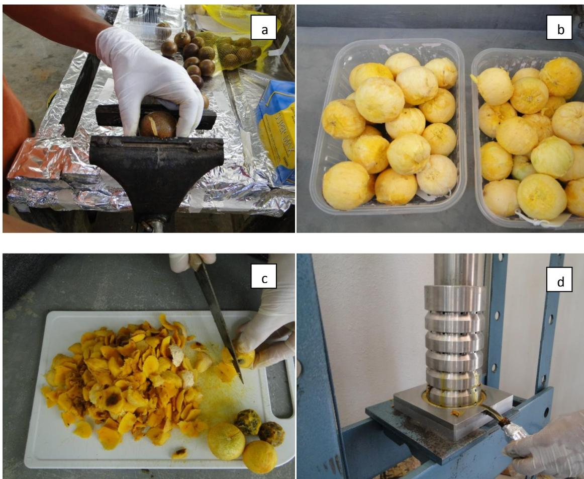
**Figura 16:** a) Rompimento do epicarpo (casca) dos frutos; b) Frutos descascados; c) Despolpamento; d) Extração do óleo e acondicionamento em frascos âmbar, envoltos por papel alumínio.
