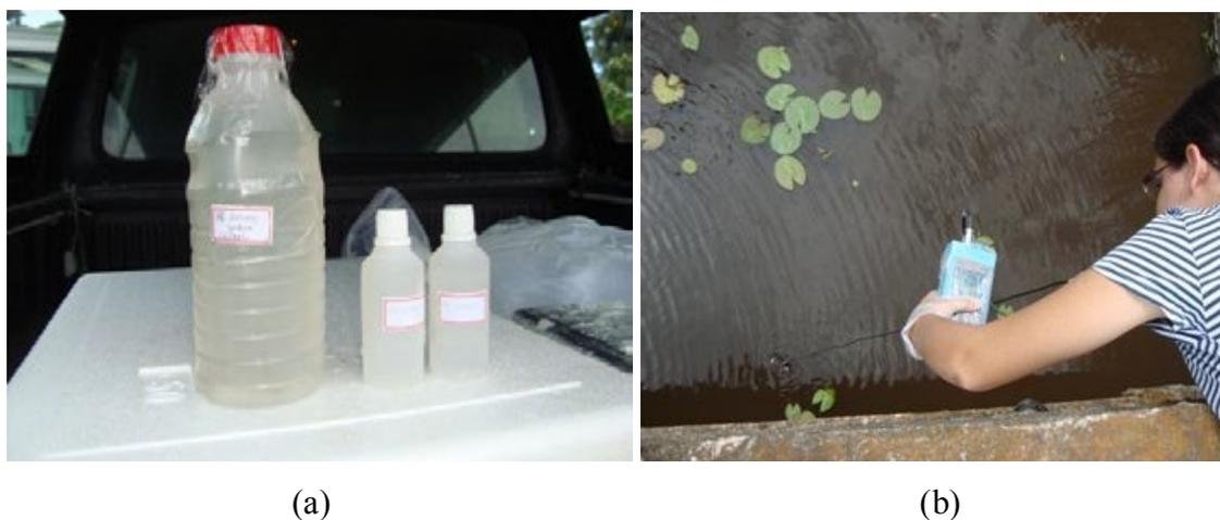
**Figura 10:** Frascos de amostragem identificados (a) e medição de parâmetros em campo (b).
