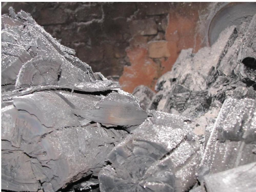
Figura 12 – Deposição de cinza sobre a massa de carvão indicando focos de fogo dentro do forno para os maiores fluxos.
