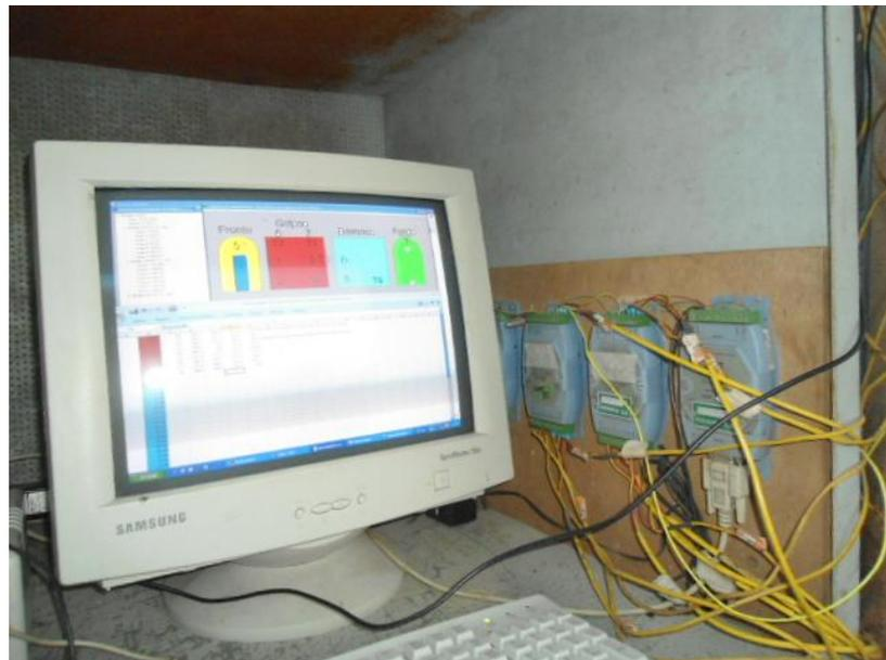
Figura 6-Sistema de aquisição de dados
