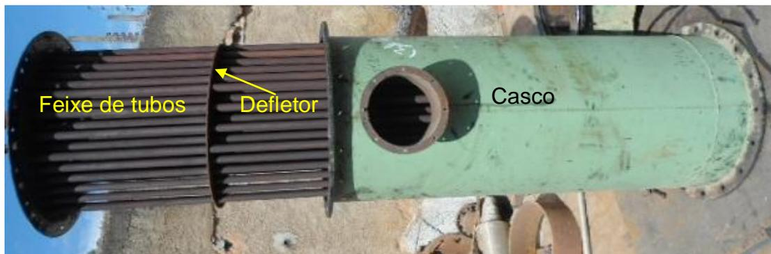
Figura 4 – Detalhe do Feixe de tubos removível e com defletores
