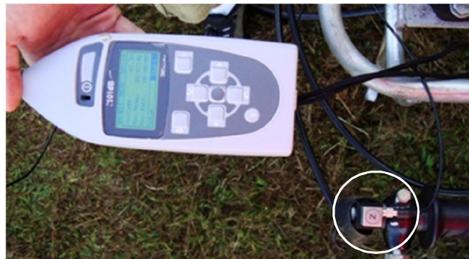
Figura 17: Montagem do sensor de vibração no motocoveador na região das mãos
