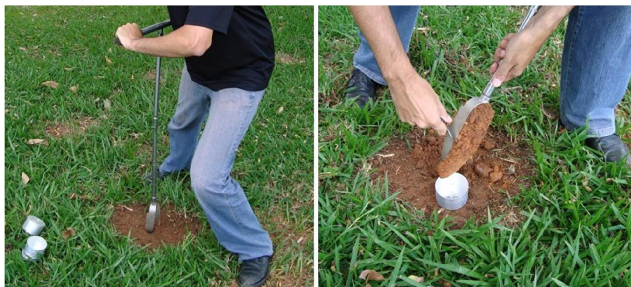
Figura 8: Coleta das amostras para determinação da umidade do solo
