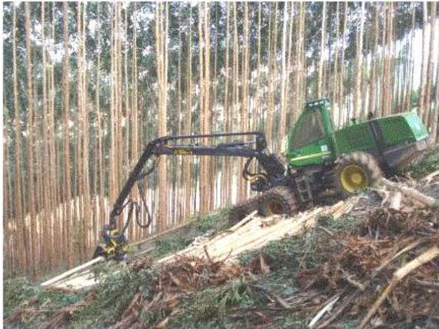
Figura 5 – Harvester marca John Deere, modelo 1270D, operando no corte de eucalipto na declividade de 33°.
