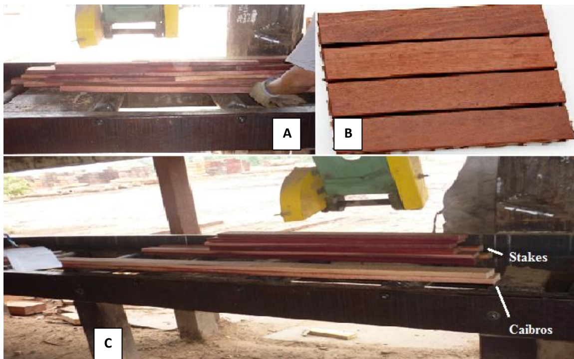
Figura 8 - Produtos e subprodutos. A) piso sólido; B) garden tiles ; C) caibros e stakes
