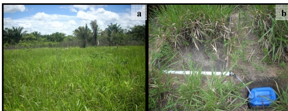
Figura 10: (a) Agroecossistema de Pastagem, área com manejo de derruba-e-queima (PQ); (b) coletor (PQ) do escoamento superficial do solo em campo com dimensão de 1m 2 .
