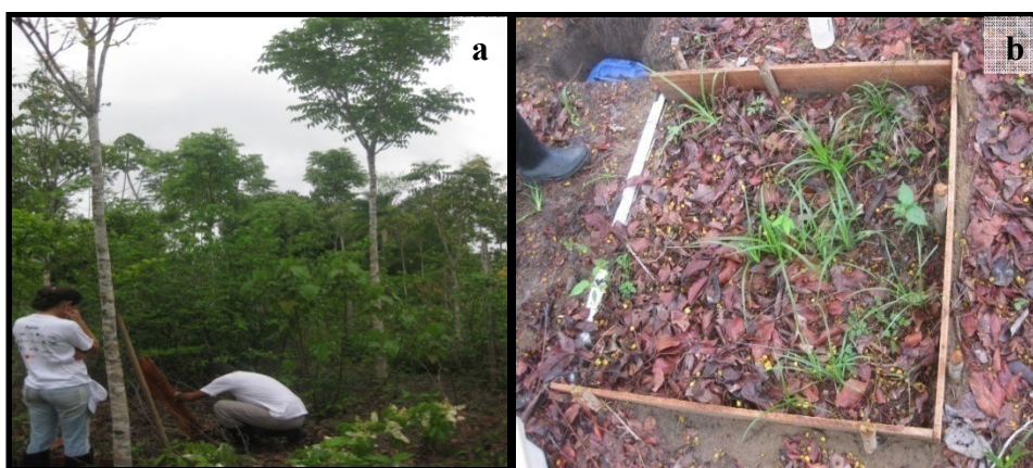
Figura 6: (a) Sistema agroflorestal com preparo de área convencional de derruba-e-queima (SQ); (b) coletor (SQ) do escoamento superficial no solo em campo com dimensão de 1m 2 .
