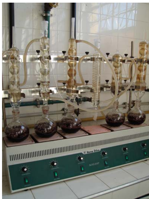
Figura 2. Extração sob refluxo para os diferentes tratamentos
