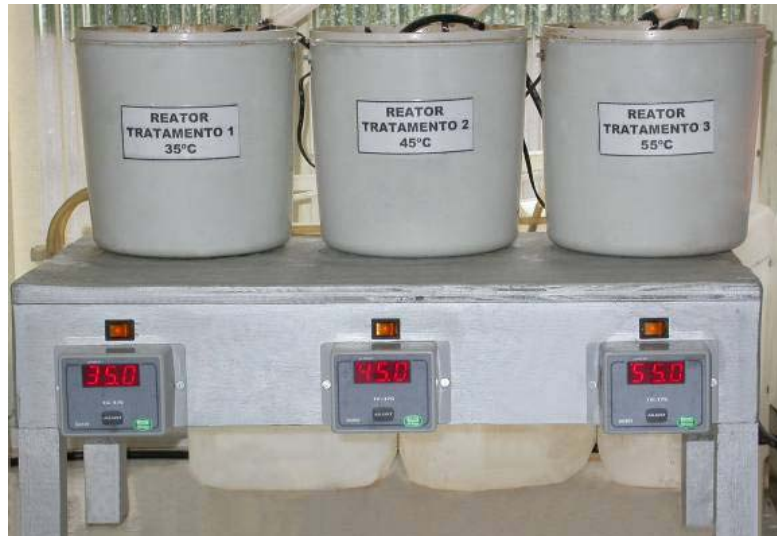
Figura 4.6. Fotografia das plantas pilotos laboratoriais composta por três biorreatores a membranas nas temperaturas de 35, 45 e 55 °C do Experimento II.
