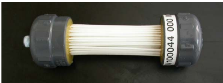
Figura 4.4. Módulos de membranas para ultrafiltração da Zenon®, modelo Zee Weed-1 (ZW-1), utilizados para a ultrafiltração do lodo biológico durante o tratamento com o biorreator a membranas.
