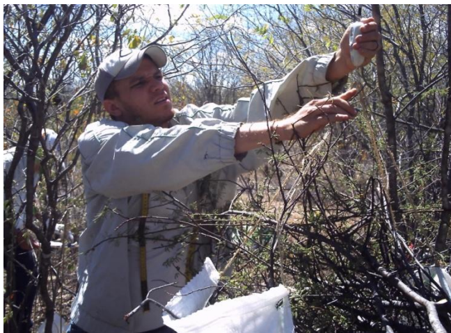
Figura 5. Pesagem dos galhos de uma das árvores abatidas em área de Caatinga no trecho Milagres-Coremas, em Coremas-PB com o auxílio de uma balança de gancho digital.
