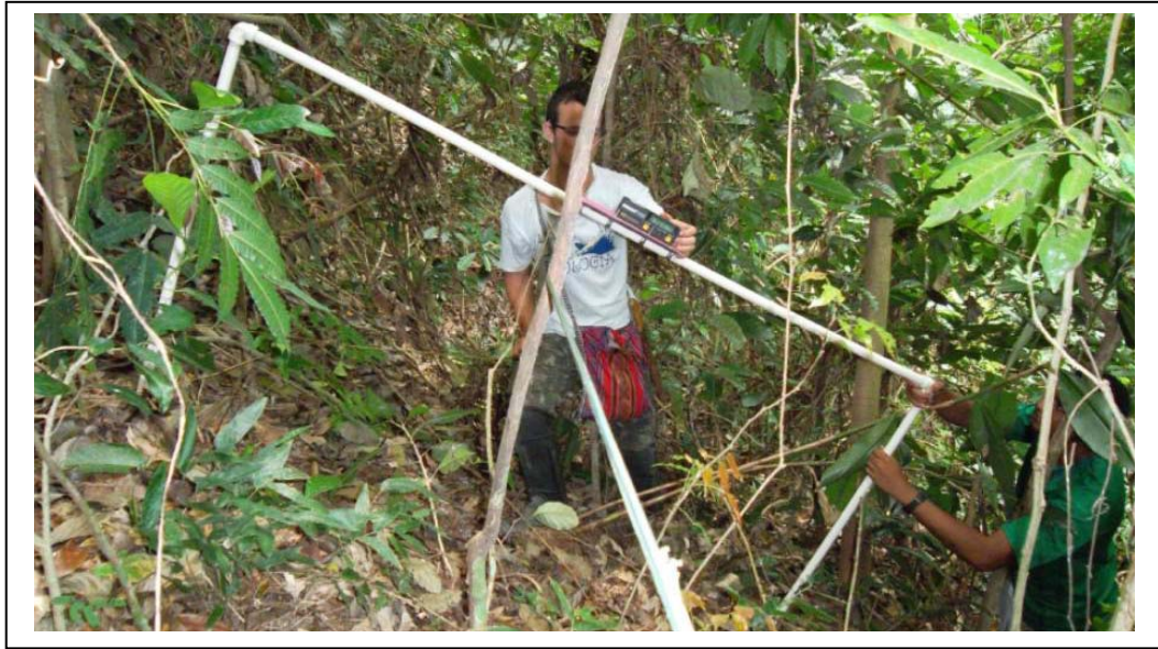
Figura 22: Fotografia do interior de um transecto no Parque Natural Municipal do Curió, Paracambi. RJ. A imagem evidencia o suporte de PVC utilizado para sustentar o clinômetro digital durante a amostragem.
