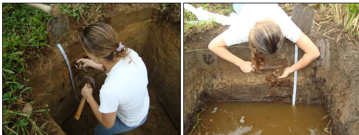
Figura 299. Coleta de amostras indeformadas de solo com anel de Kopeck (esquerda) e descrição de perfil e coleta de amostras deformadas de solo (direita).
