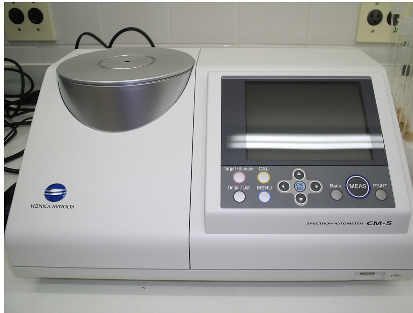
FIGURA 9 – ESPECTROFOTÔMETRO KONICA MINOLTA CM-5. FONTE: A autora, 2013.
