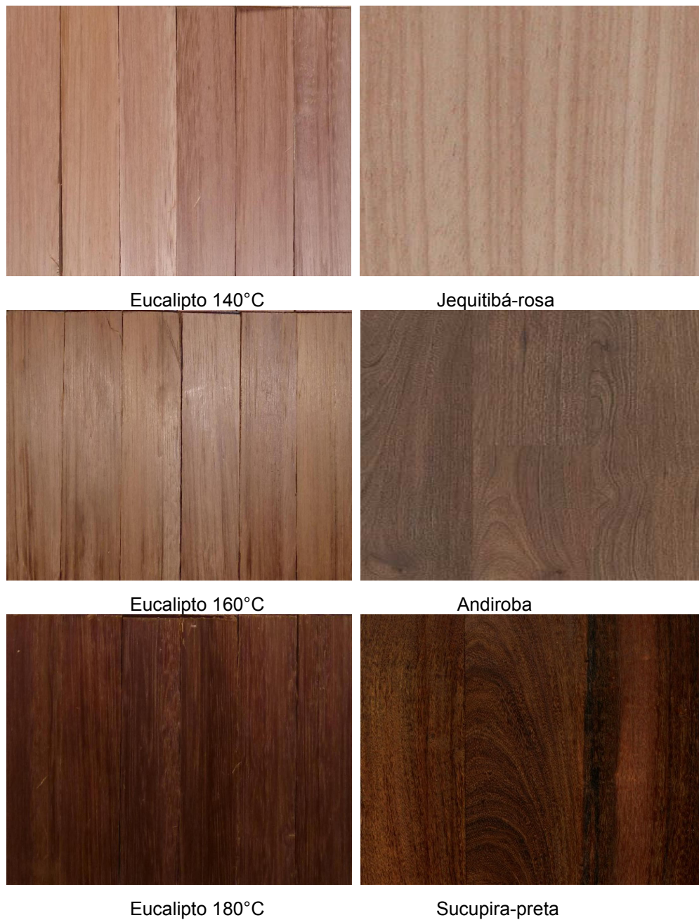
FIGURA 13 – COMPARAÇÃO VISUAL ENTRE O ASPECTO DA MADEIRA MODIFICADA TERMICAMENTE E DAS ESPÉCIES TOMADAS COMO REFERÊNCIA.
