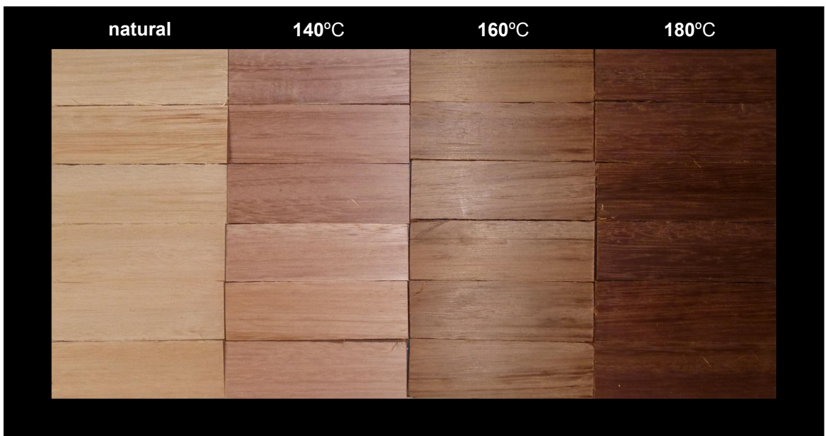
FIGURA 11 – APARÊNCIA DA MADEIRA DE ANTES E APÓS OS TRATAMENTOS TÉRMICOS.
