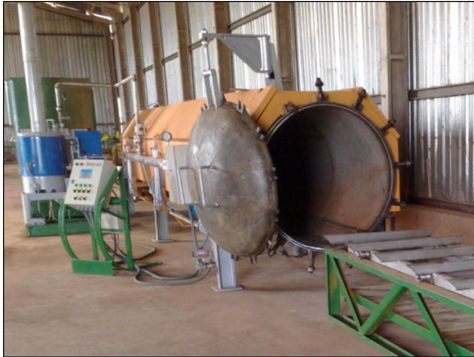
FIGURA 8 – VISTA GERAL DO EQUIPAMENTO UTILIZADO NO PROCESSO DE MODIFICAÇÃO TÉRMICA VAP HolzSysteme® FONTE: Batista (2012).
