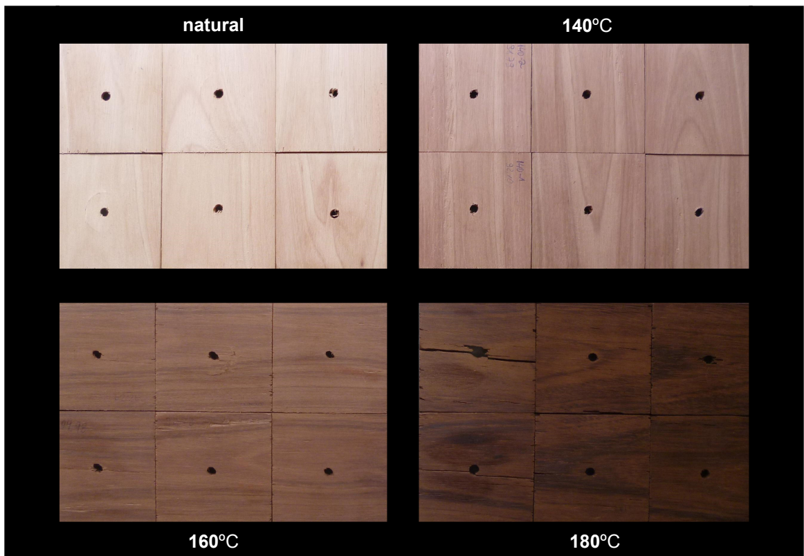
FIGURA 10 – APARÊNCIA NATURAL DA MADEIRA E APÓS OS TRATAMENTOS TÉRMICOS.
