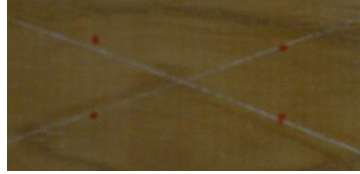
Figura 16 - Teste de aderência de verniz à base de nitrocelulose para corte em X com 0% de destacamento.
