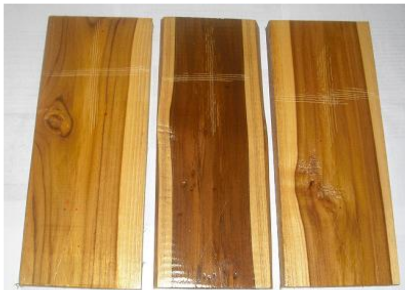
Figura 12 - Corpos-de-prova com verniz PU para espaçamentos 6x2m, 5mx2m e 4mx2m.
