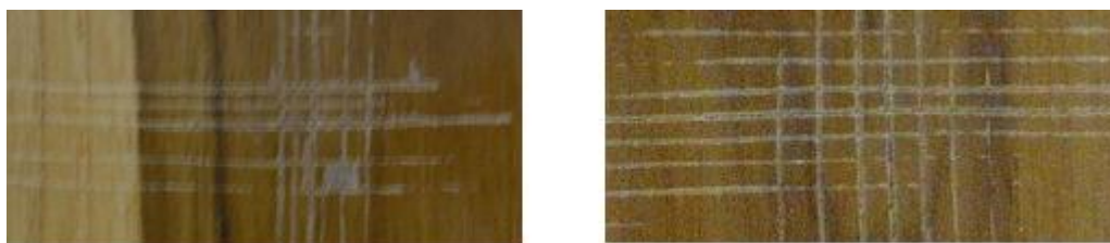
Figura 14 - Teste de aderência de verniz à base de PU para corte em grade com 35% e 0% de destacamento respectivamente.
