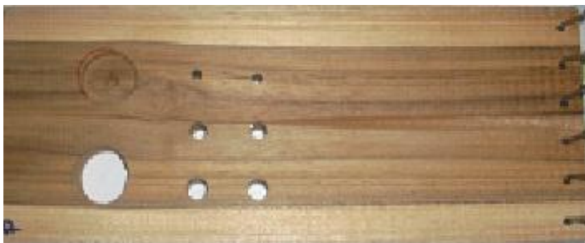
Figura 5 Corpo-de-prova de teca jovem após os ensaios de Furação para dobradiça não passante e passante, furação para cavilha e fendilhamento por prego executados na face aplainada.
