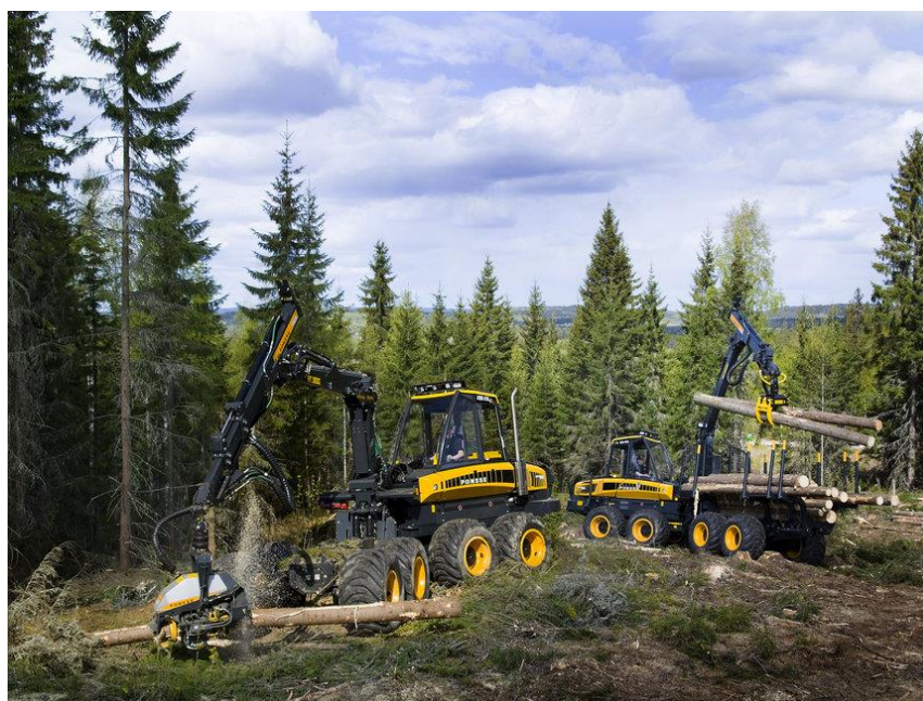
FIGURA 2 – DETALHE DO DUAL HARWARDER. FONTE: PONSEE (2013)
