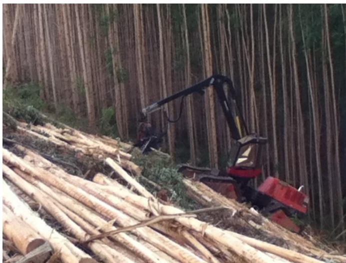
FIGURA 9 – HARVESTER 911.3 X3M OPERANDO EM RELEVO ACIDENTADO EM POVOAMENTO DE EUCALIPTO.
