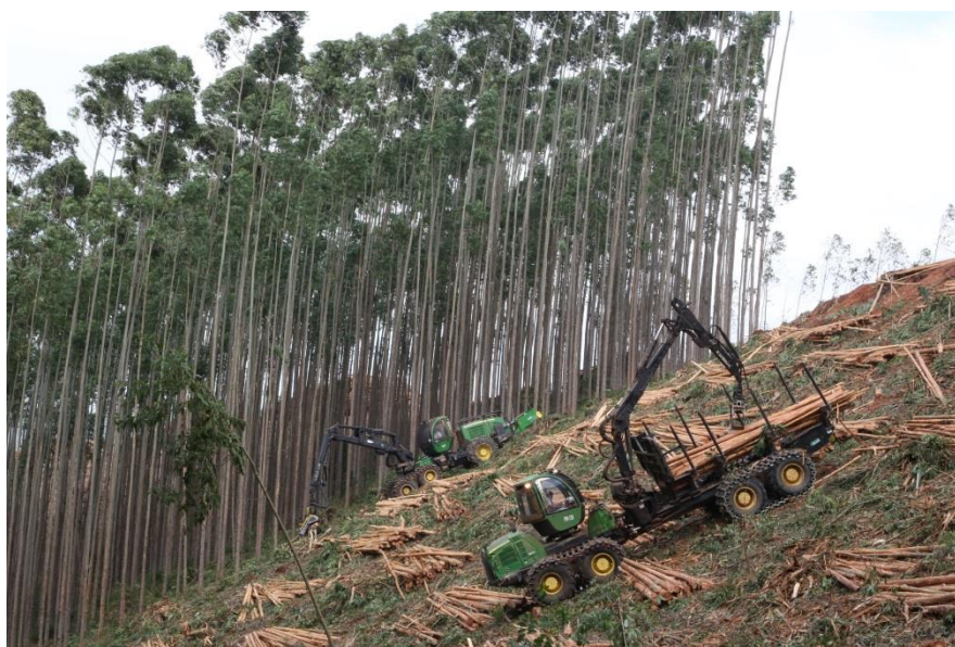
FIGURA 6 – SISTEMA DE COLHEITA CUT-TO-LENGTH COM HARVESTER E FORWARDER COM GUINCHO DE TRAÇÃO AUXILIAR.
