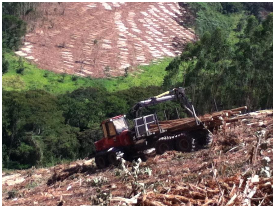
FIGURA 13 – FORWARDER MODELO 860.4 REALIZANDO A OPERAÇÃO DE CARREGAMENTO
