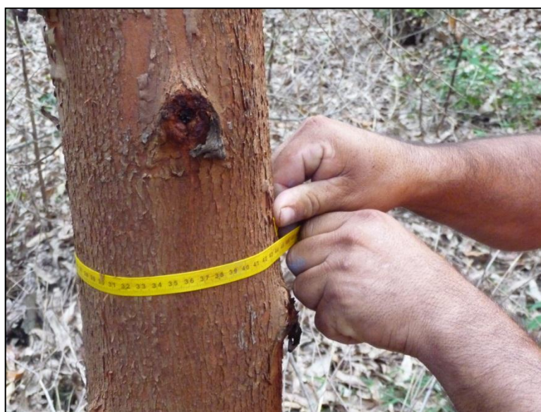
FIGURA 3.7 – MEDIÇÃO DO CAP UTILIZANDO TRENA DE LONA
