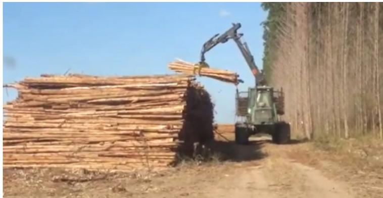
Figura 12 - Operação de formação de pilha do “Forwarder”
