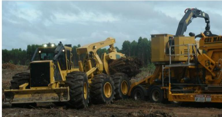
Figura 15 - o “Skidder” entregando o feixe de madeira para a máquina “Flail”
