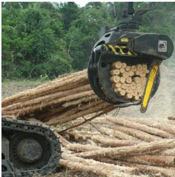
Figura 10 - Cabeçote “Garra-Traçadora” Rotobec
