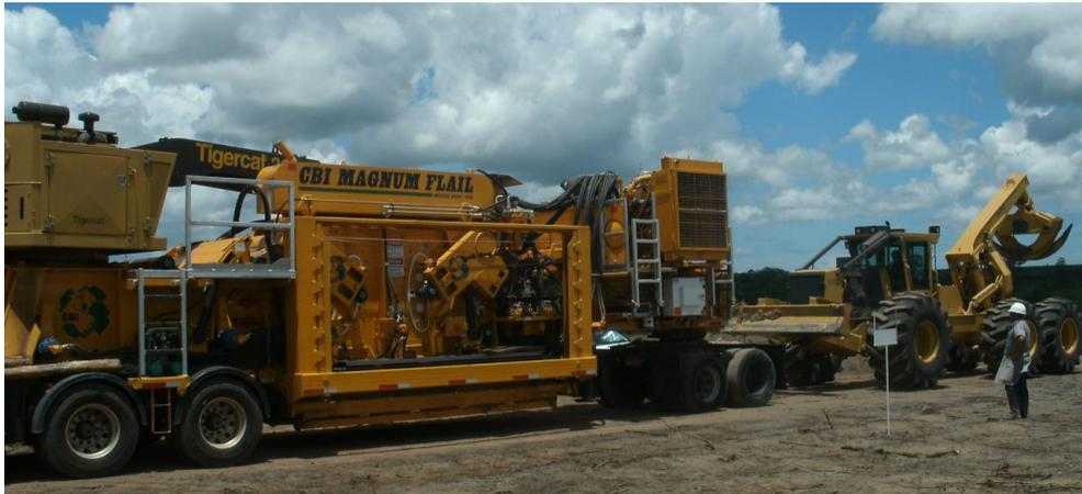
Figura 47 - Movimentação da “Flail” conectada à “Dolly” sendo puxada pelo “Skidder”
