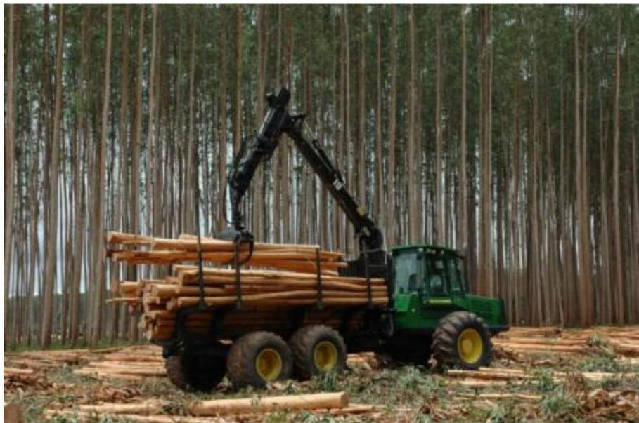
Figura 3 - Máquina “Forwarder”, da John Deere 1710
