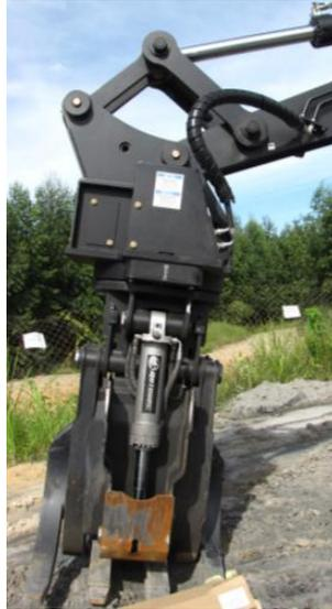
Figura 9 - Cabeçote “Power-Clamp” da Rotobec
