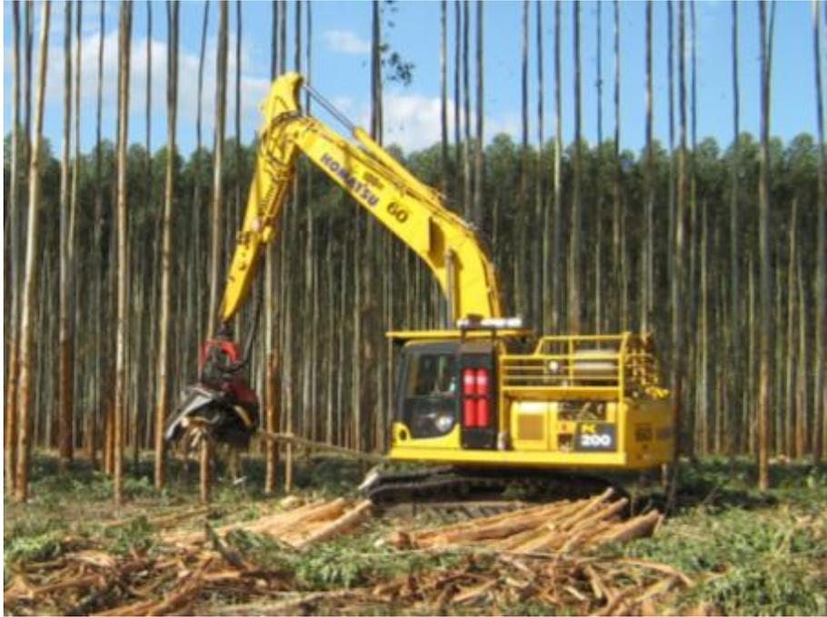
Figura 1 - Máquina Base PC 200 da Komatsu
