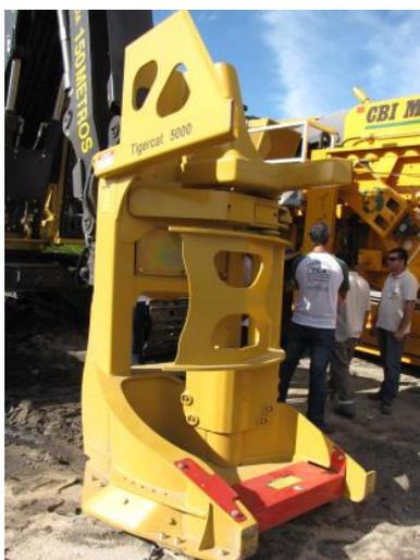
Figura 5 - Cabeçote “Feller-buncher” modelo 5000 da Tigercat
