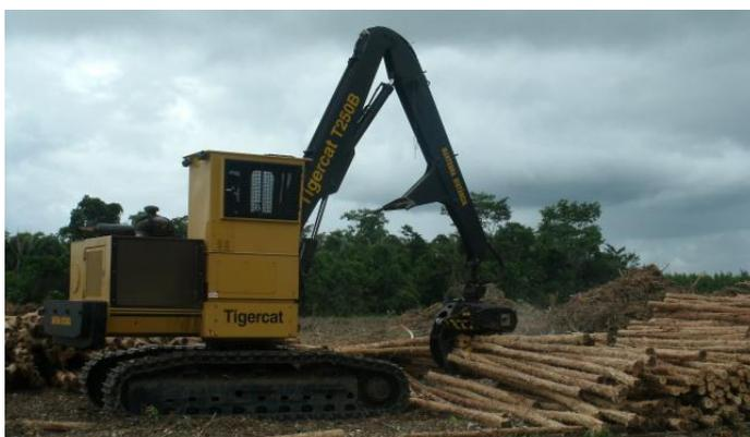
Figura 19 - Máquina “Garra-Traçadora” realizando o Traçamento das árvores inteiras descascadas em toras de 6,3 metros de comprimento e formando pilha de madeira de até 3,0 metros de altura
