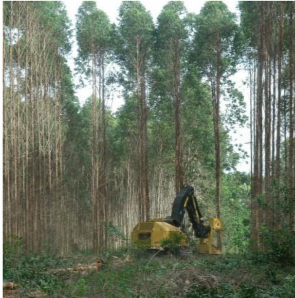
Figura 13 - Máquina Feller-buncher realizando corte de árvores num eito de quatro linhas de plantio
