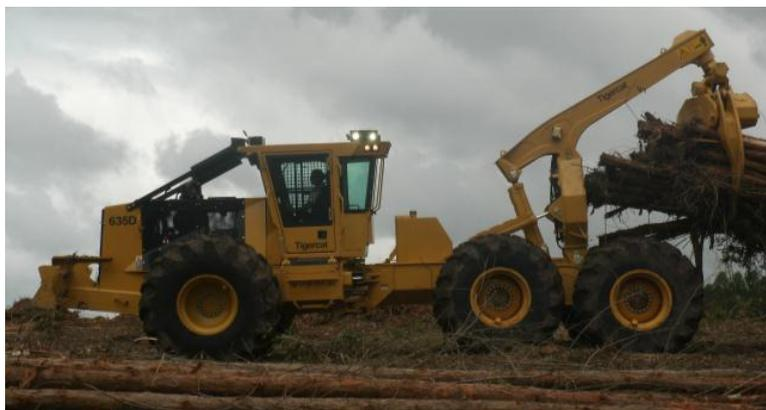
Figura 14 - o “Skidder” arrastando feixe de árvores inteiras a serem entregues para o descascamento na máquina “Flail”
