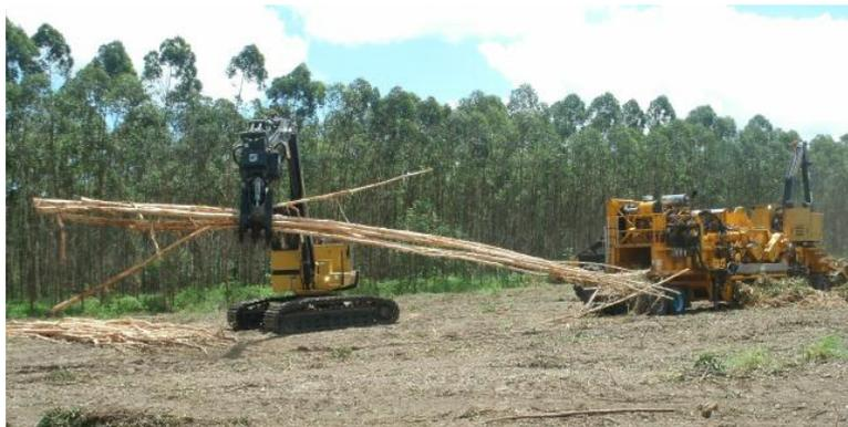
Figura 17 - Máquina “Power-Clamp” retirando os feixes de árvores da máquina “Flail” e criando estaleiro de árvores inteiras descascadas
