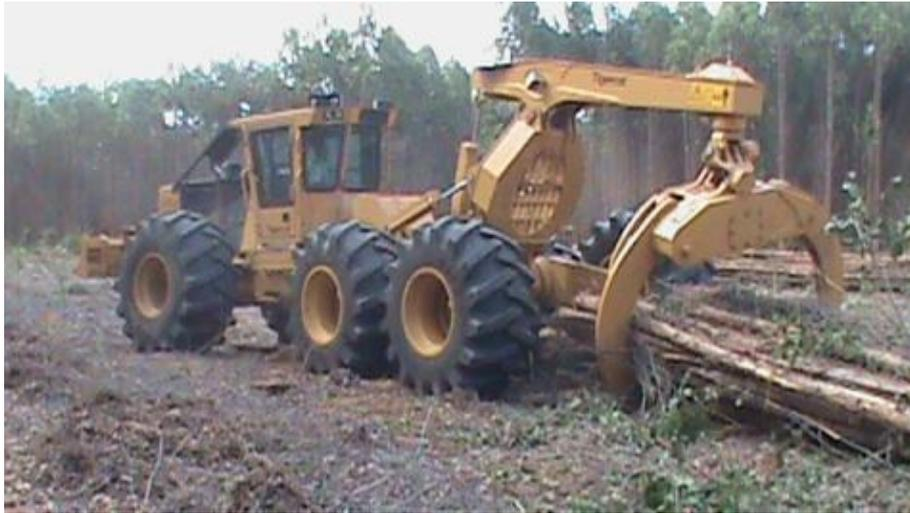
Figura 6 - Máquina “Skidder” da Tigercat
