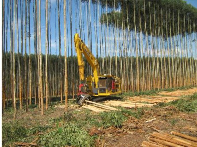
Figura 11 - Sentido de deslocamento da “Harvester” e eito de quatro linhas
