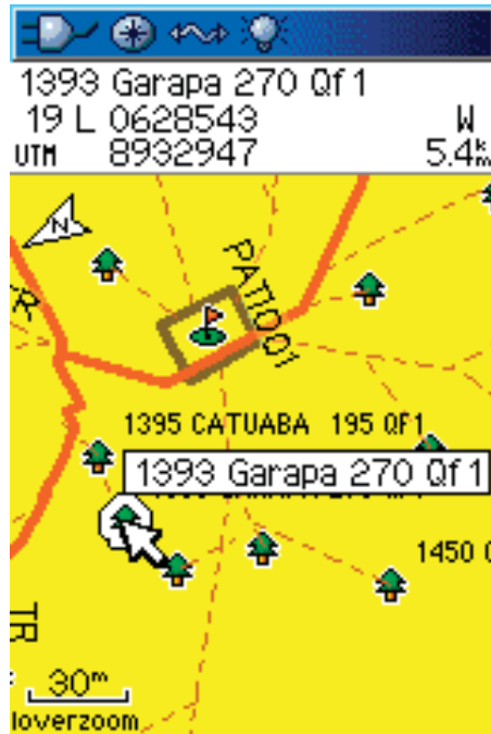
Figura 16. Tela de mapas do GPSmap76CSx (Garmin) com o mapa dinâmico de exploração florestal, destacando-se a placa de identificação da árvore, nome vulgar, CAP e qualidade do fuste, UPA 02, Fazenda Rio Brilhante, Porto Acre, 2009.
