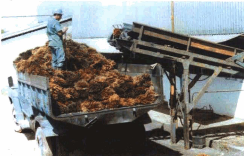
Figura 1. Vista de um caminhão basculante sendo carregado com engaços.
