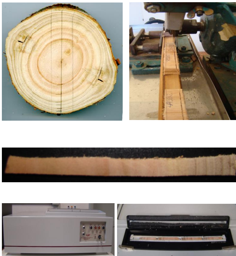
Figura 6 – Seção transversal do disco do lenho de árvore de Eucalyptus urophylla com a demarcação da amostra diametral (A); amostra diametral do lenho colada em suporte de madeira e corte das amostras transversais do lenho em equipamento de dupla serra (B); amostra radial do lenho (2 mm) de espessura (C); equipamento de raios X QTRS-01X e suporte metálico com as do lenho (D e E)
