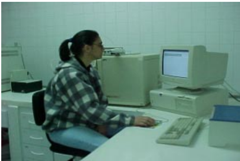
Fig. 6. Análise olfatométrica através da técnica OSME. Detalhe do julgador percebendo o aroma e utilizando o mouse do computador para registrar a sua intensidade diretamente na tela do monitor.
