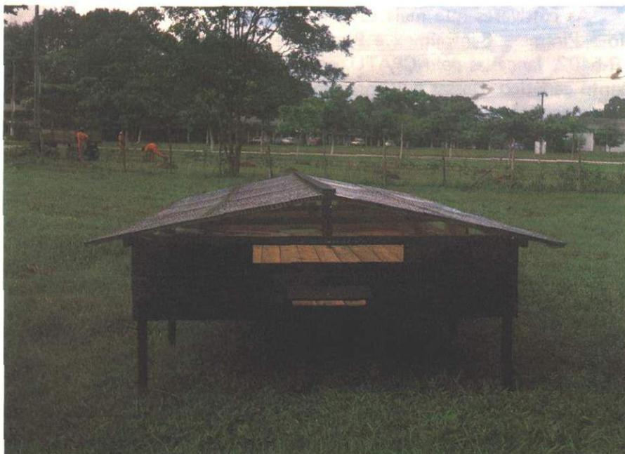
FIG. 32. O uso de energia solar apresenta-se eficiente na secagem de grãos a nível de pequenas propriedades. Na foto modelo de um protótipo de secador solar desenvolvido pelo CPATU, empregado para redução do teor de umidade do milho e outros grãos. (Gentileza do Dr. José Aderaldo de Araújo).
