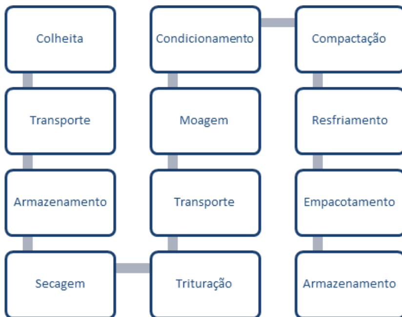
Figura 5: Etapas pelas quais passa a matéria-prima até sua transformação em briquetes ou péletes. (NILSON et al., 2011).
