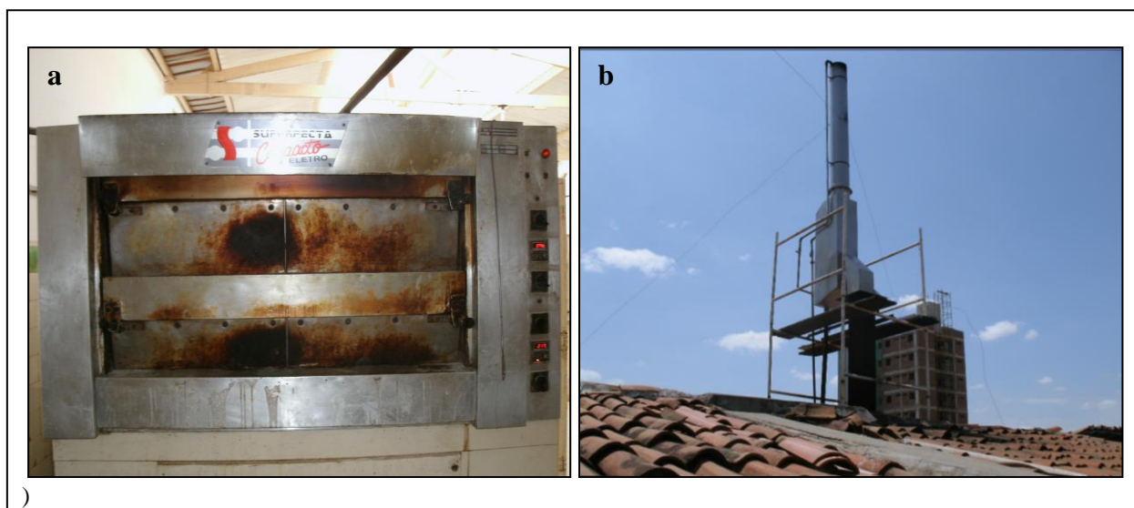
Figura 5 – Equipamentos da padaria que utiliza tecnologia limpa na cidade de Patos – PB. Detalhes do forno (a) e do ecofiltro (b)
