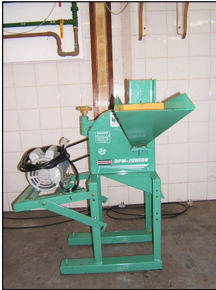
Figura 13. Trituradora de forragem, utilizada para triturar os resíduos utilizados no presente trabalho.
