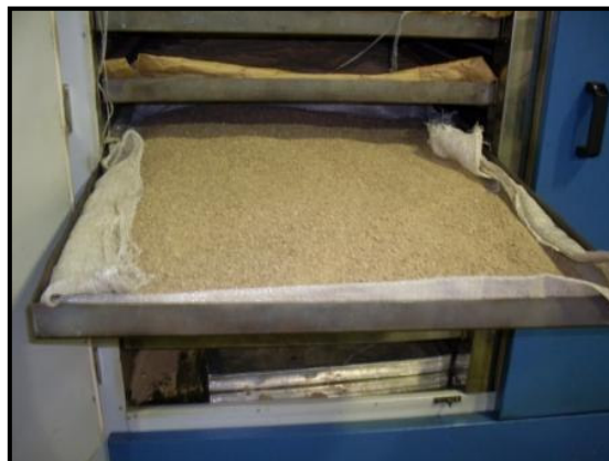
Figuras 8 e 9. Disposição dos tratamentos nas bandejas para a correção da umidade em estufa.
