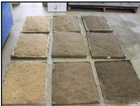
Figuras 8 e 9. Disposição dos tratamentos nas bandejas para a correção da umidade em estufa.
