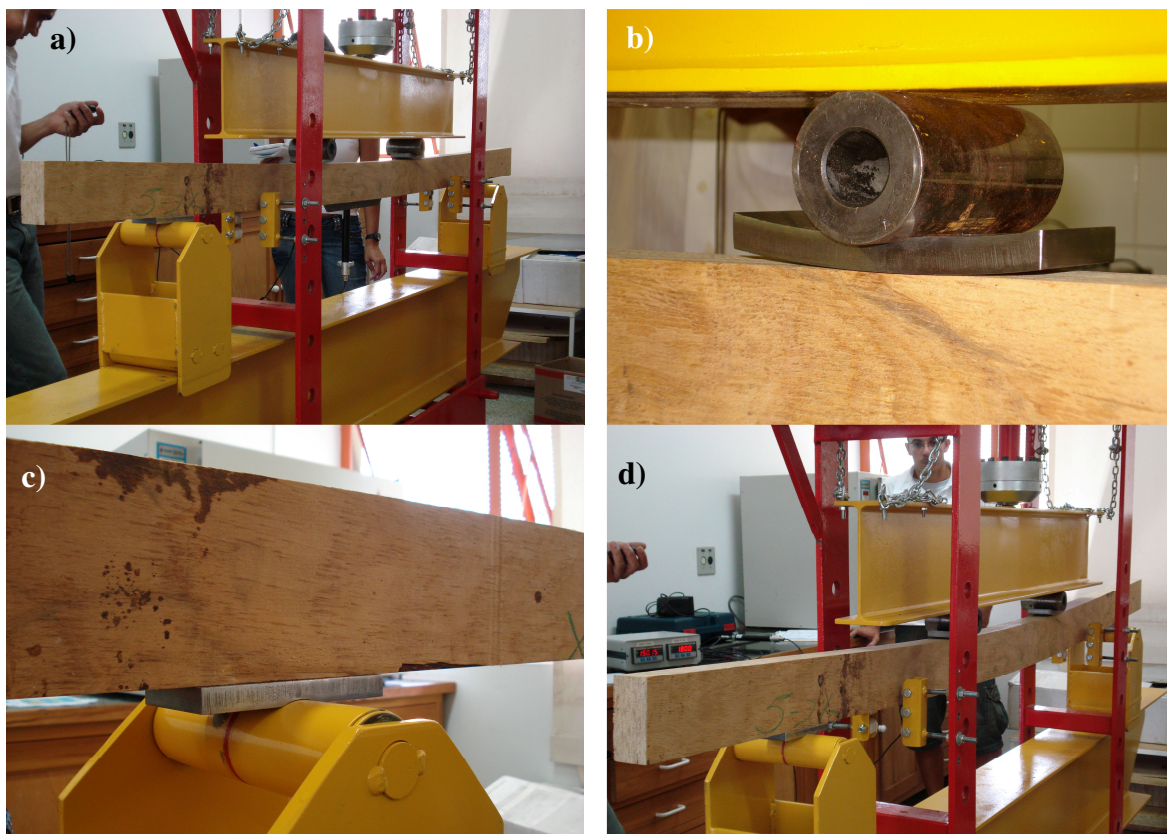
Figura 8 – Ensaio de flexão estática em relação ao eixo de maior inércia. a) vista geral do equipamento; b) detalhe do rolete de transferência de carga; c) dispositivo de contato entre a viga e o apoio; d) contraventamento.
