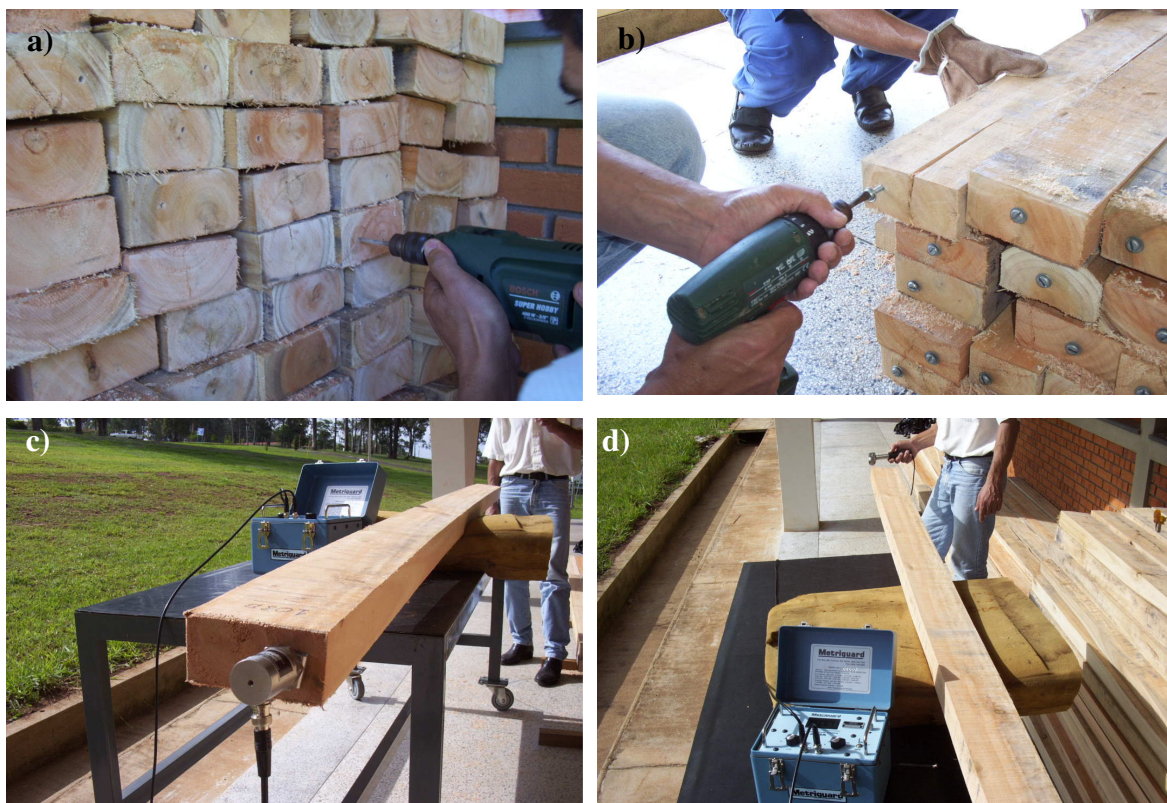
Figura 5 – Ensaio não-destrutivo de ondas de tensão nas vigas de Eucalyptus . Preparação do material a) Pré-furação; b) fixação dos parafusos; c) acelerômetro de chegada; d) execução do ensaio com o auxílio de um martelo instrumentado.
