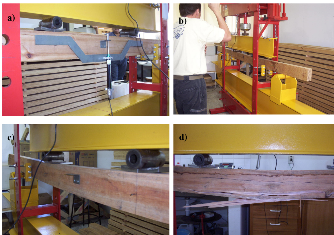
Figura 9 – Ensaio de flexão estática em relação ao eixo de maior inércia. a) aparato para medição da deformação na viga; b) aplicação da carga de carregamento; c) continuidade do ensaio após retirada do extensômetro; d) ruptura da peça.
