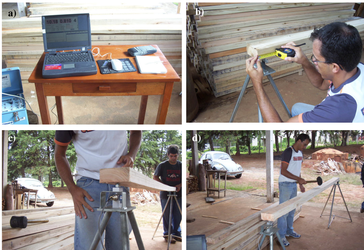
Figura 7 – Ensaio não-destrutivo de vibração transversal na madeira de Eucalyptus . a) aparato modelo 340 da Metriguard ; b) ajuste do vão central ; c) detalhe da célula de carga; d) execução do ensaio através de um impacto na porção central da peça.
