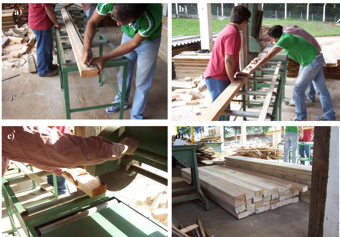
Figura 3 - Processamento mecânico da madeira de Eucalyptus do programa experimental. a) marcação das dimensões longitudinais desejadas; b) e c) operação de destopo; d) aspecto final das peças.
