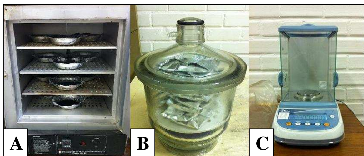
Figura 9: A – Estufa Fanem (315 SE) com as amostras em pratos de alumínio; B – Amostras acondicionadas em dessecador; C – Balança Bel (UMARK 210 Classe I).
