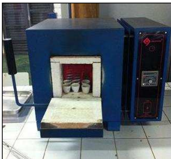
Figura 7: Mufla Quimis (Q.318.24) com os cadinhos contendo as amostras para análise do teor de cinzas.
