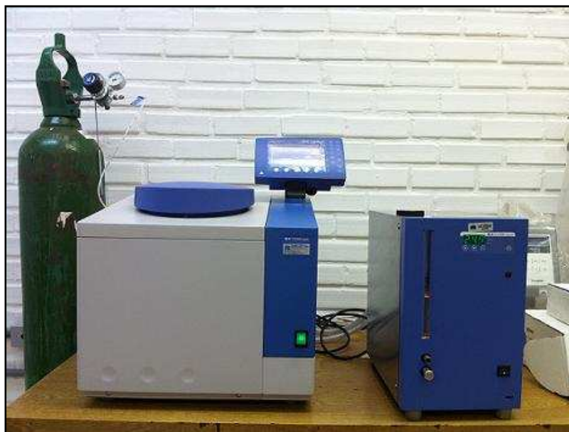
Figura 10: Bomba calorimétrica IKA (C2000 Basic) acoplado a aparelho para banho de refrigeração IKA (KV 600 Digital).
