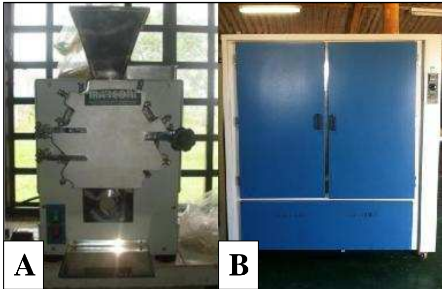
Figura 4: A – Moinho de facas Marconi (MA 680); B – Estufa Marconi (MA 035).
