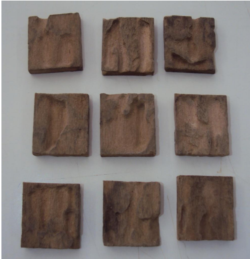
Figura 11 – Corpos de prova da madeira de Platanus sp. atacados após ensaio de alimentação forçada aos cupins Nasutitermes sp.
