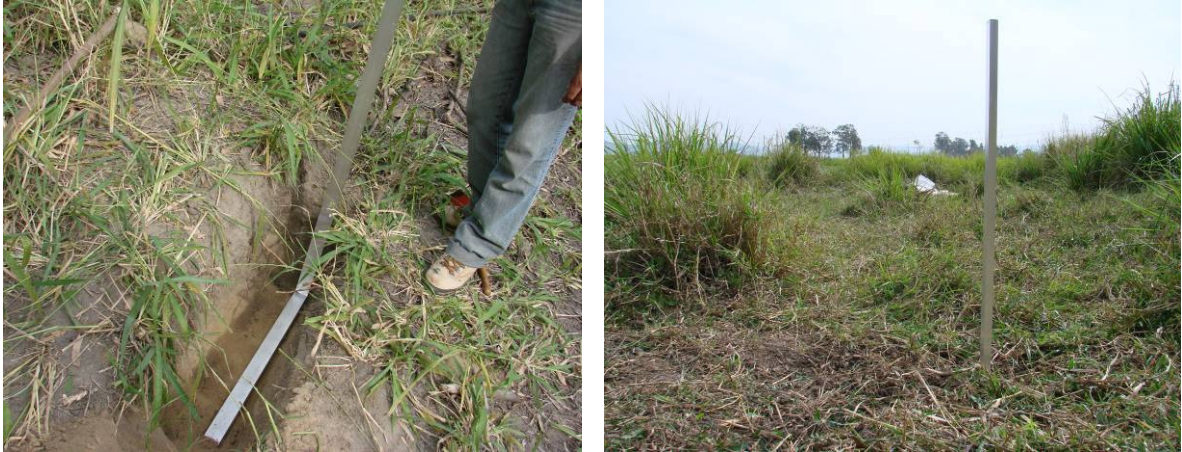
Figura 3: Bastão de alumínio utilizado para determinar a velocidade de propagação do sinal.
