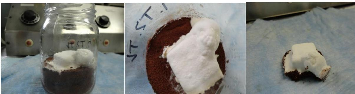
Figura 3: Corpos-de-prova submetidos ao ataque do fungo *T. versicolor*.
