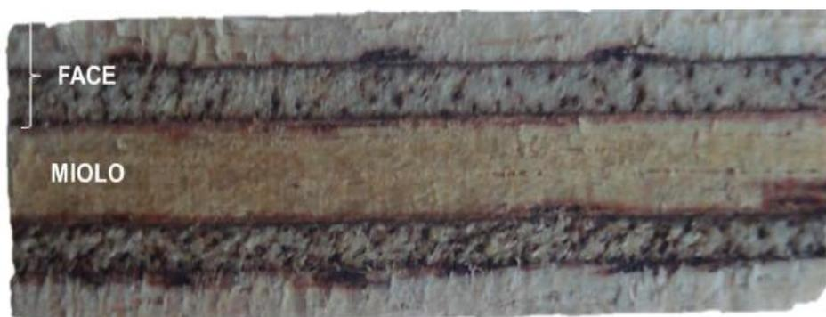
Figura 1 - Seção transversal do painel compensado com cinco lâminas. Fonte: ARRUDA (2012).
